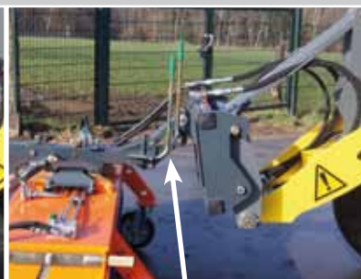
Mini-/front-læsser med parallellogram og penduludligning incl. højdeangivelse
